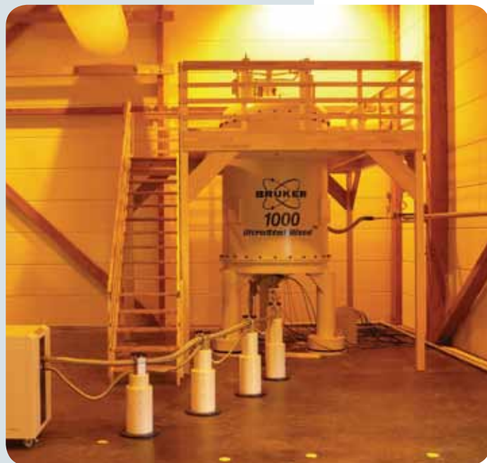
World's first 1GHz (23.5 T) UltraStabilized magnet installed at Centre de RMN à Très Haut Champs, Lyon, Fr. Courtesy: Prof. L. Emsley.
